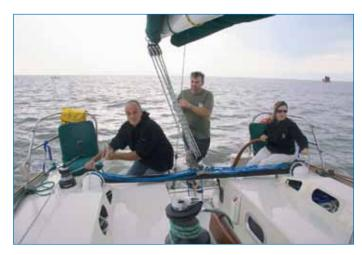
Au moment de virer, l'équipage peut rester derrière la barre d'écoute. La barreuse peut choquer la contre écoute sans se déplacer de son poste. Notez la présence des compas, juste devant les postes de barre. L'avant du cockpit reste complètement libre de toute manœuvre.
