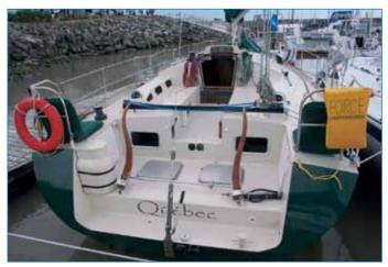
Les coffres de rangement sont situés dans le plancher et sur les parois latérales du cockpit. Les hublots ouvrent dans le carré. Le pataras hydraulique permet de bien contrôler la flèche d'étai. Le cylindre hydraulique du pilote automatique risque d'avoir la vie dure ainsi exposé.
