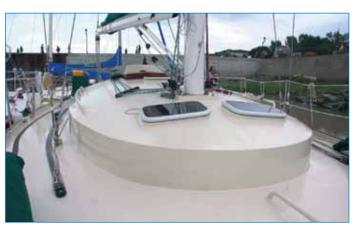
Les jolies formes arrondies du rouf, un véritable coup de maître de la part du chaudronnier. Partout, le degré de finition de la soudure est irréprochable. Notez les mains courantes sur le sommet du rouf et au centre du pont.
