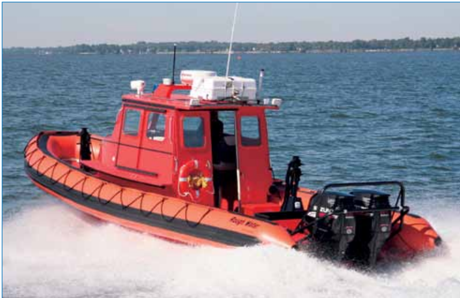
Les deux moteurs Suzuki de 175 CV poussent le Rough Water jusqu'à 40 nœuds. Remarquez les bittes d'amarrage à l'avant et à l'arrière.
