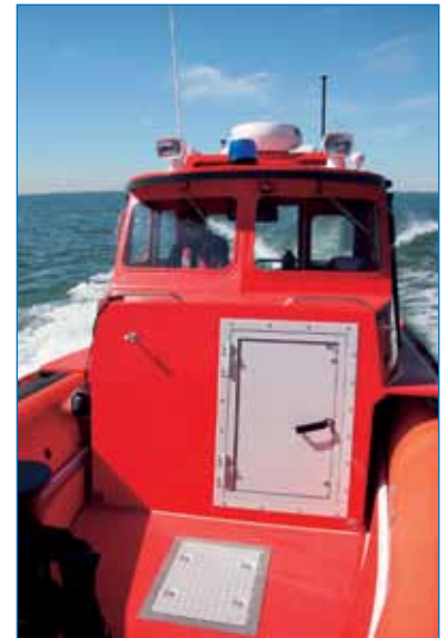
Une porte étanche fait communiquer l'habitacle et la plage avant. Le coffre de mouillage au premier plan est recouvert d'un capot en acier inoxydable.
