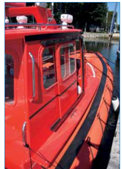
Les marchepieds en fibre de verre permettent de circuler autour de la cabine. Les mains courantes offrent de bonnes prises pour se cramponner.
