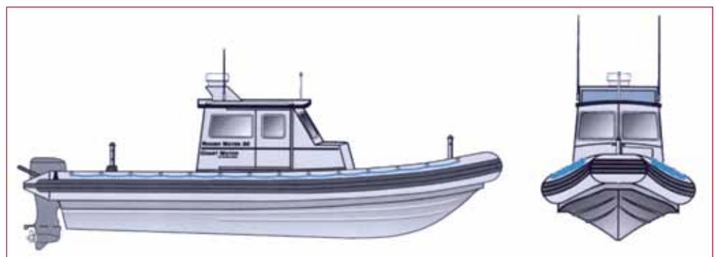
Les marchepieds en fibre de verre permettent de circuler autour de la cabine. Les mains courantes offrent de bonnes prises pour se cramponner.
