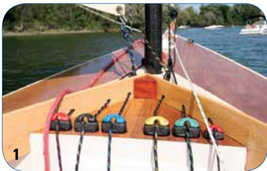
1 La batterie de coinceurs au pied du mât. L'anneau de cunningham sert de point d'amure.
