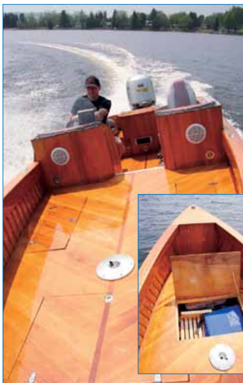
Un pont bien dégagé dans lequel sont logés les coffres de rangement. Au centre, un logement pour un siège.
