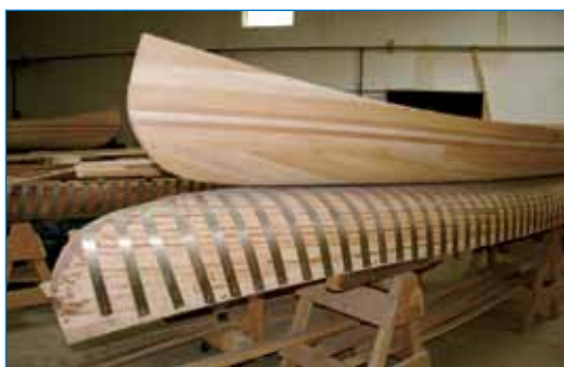
Tous les bateaux sont construits sur des moules mâles intégrant des lames d'inox servant à emboutir les clous fixant le bordé.
