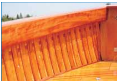
Notez la multiplication des membrures au-dessus du solide liston qui ceinture le bateau.
