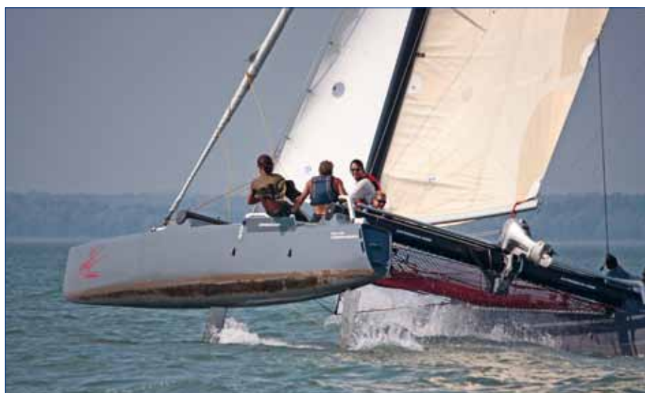
Les coques ont été modifiées pour recevoir les nouvelles poutres en carbone. Le gain de poids significatif a dopé les performances.
