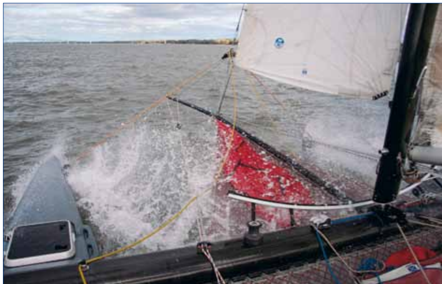
Une bonne partie des manœuvres sont installées en pied de mât. Le rail courbe sur lequel revient l'écoute de foc est monté sur des pivots souples qui lui permettent de s'orienter dans l'axe du point de tire.
