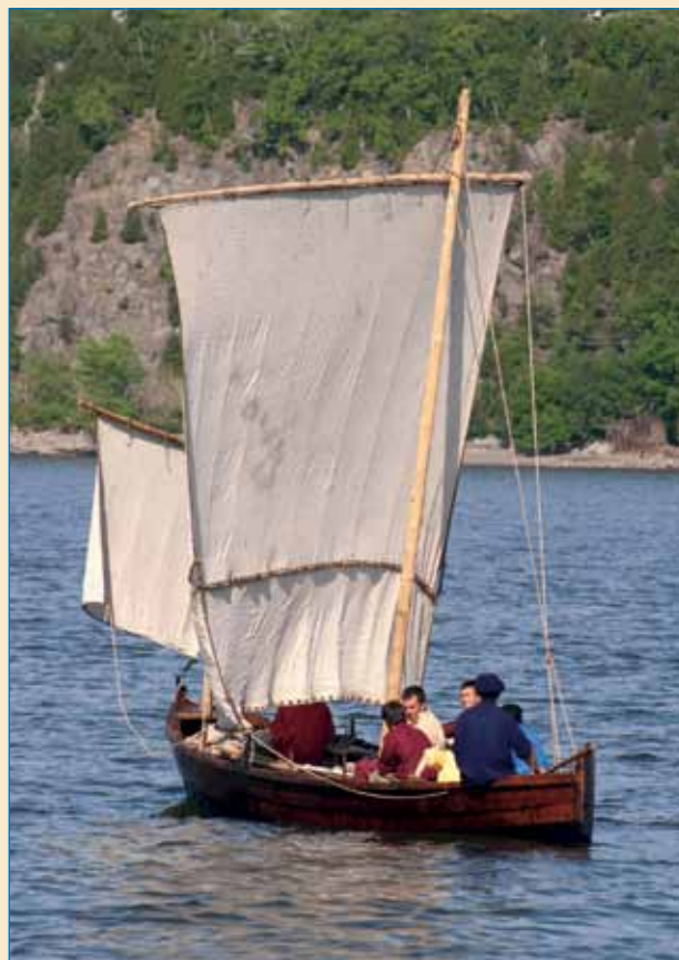
La chalupa est gréée au tiers et ses espars sont amovibles. Les voiles sont en fibre de lin.
