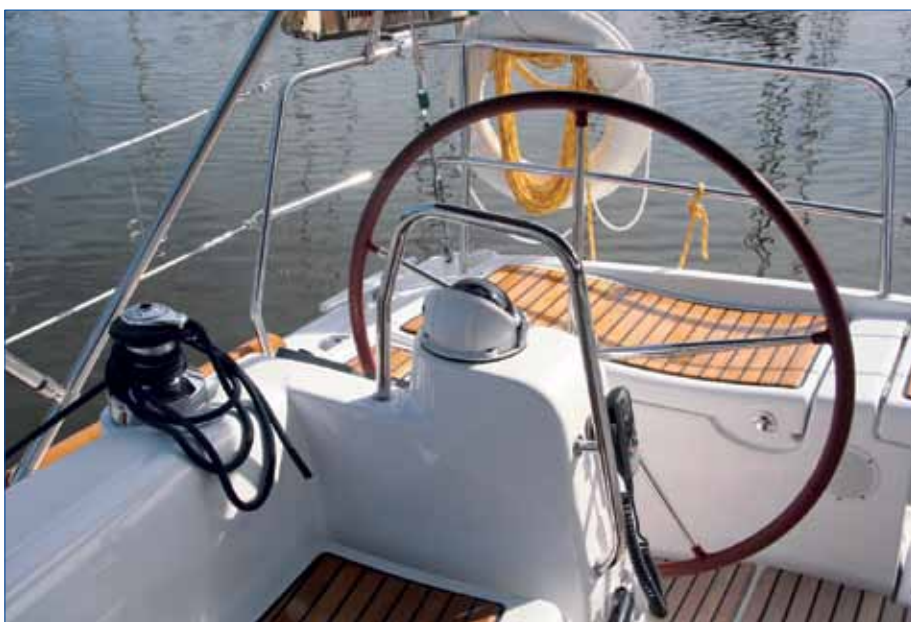
Le poste de barre s'est révélé confortable à l'usage. Le winch de génois est à portée de main du barreur.
