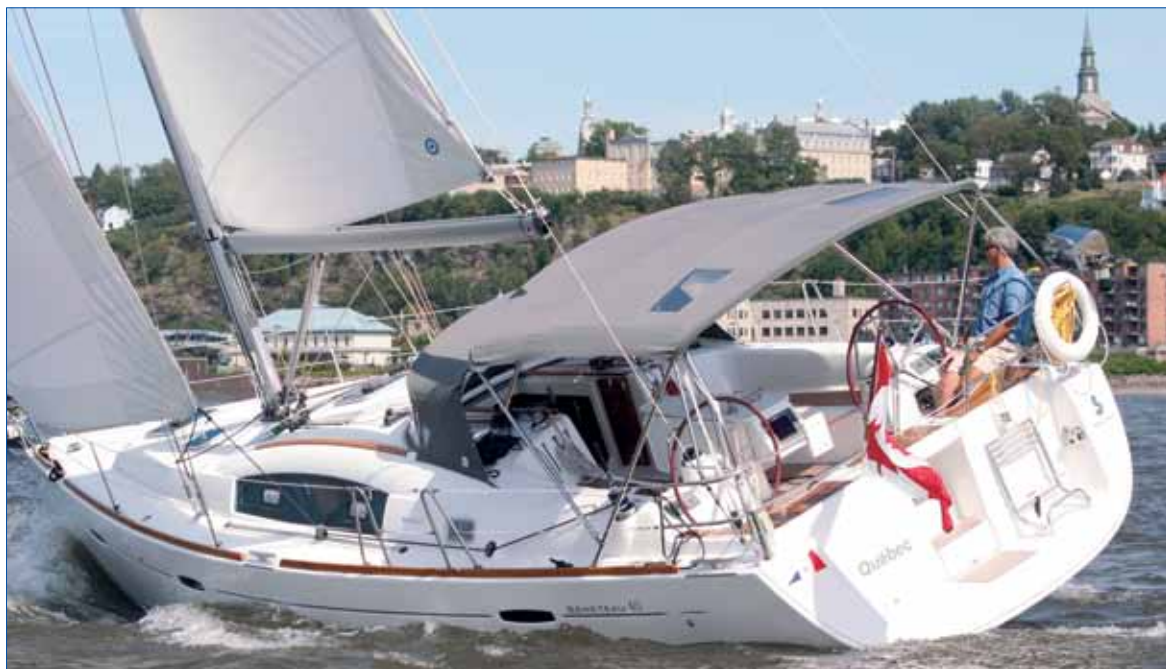
On remarque ici la largeur de la carène qui profite d'une importante stabilité de forme.
