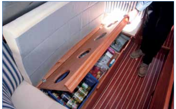
Les supports des banquettes montés sur charnières et dotés de trous d'aération. Pratique pour accéder aux réserves et bien pensé pour la ventilation.
