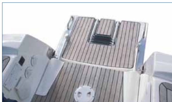
Deux vérins électriques logés de part et d'autre sur le plancher du cockpit permettent d'abaisser le tableau arrière pour le transformer en plate-forme.
