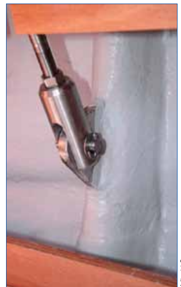
Le tirant des cadènes latérales est solidaire d'une structure en acier qui ceinture toute la coque du bateau, du pont jusqu'aux varangues: du costaud.
