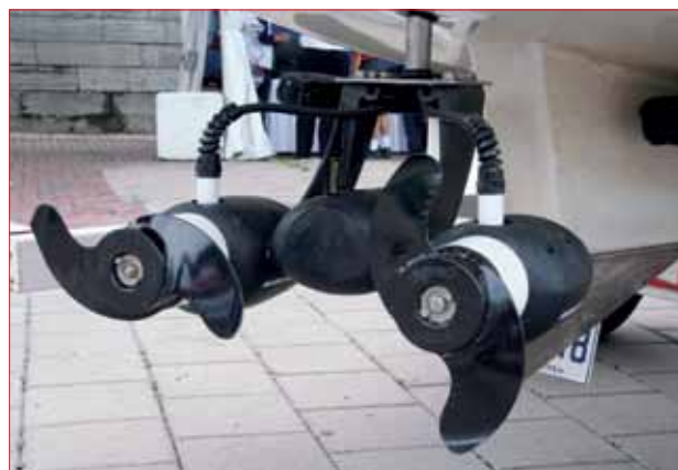
Les deux moteurs Minn-Kota ont pris la place du safran et pivotent sur sa mèche.
