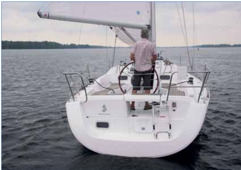
Un bateau large jusqu'à l'arrière qui profite d'un cockpit spacieux. Le double pataras dégage complètement l'accès vers la jupe.
