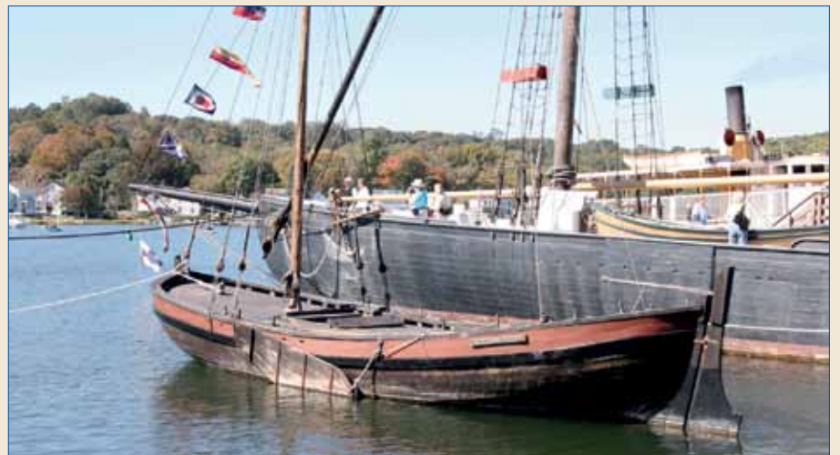
L' Elizabeth Tilley est une réplique d'une barque à dérives latérales, construite originalement en 1628 par les premiers colons de Nouvelle-Angleterre. La barque de 38 pieds a été lancée en 2003.
