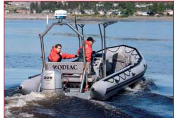
On aperçoit ici très bien la plate-forme d'aluminium rapportée sur l'arrière de la carène. Elle repousse le moteur de 0,60 m vers l'arrière et sert de base de fixation à l'arche qui supporte les antennes et la banquette arrière.
