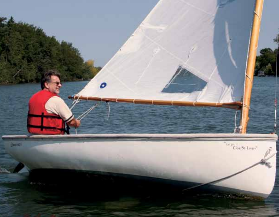
Louis Ducharme en train de tirer des bords sur son Bras d'Or 11 sur la rivière Richelieu devant l'île de Jeannotte. Remarquez le bourrelet textile qui ceinture le livet pour absorber les chocs à l'accostage.
